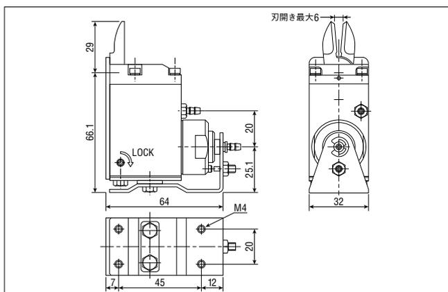
向に廻せば刃先は閉じ、OPENの方向に廻せば刃先は開きます。ご希望の刃開きに調整した後、ロックボルトを矢印の方向に締め付ければ、刃開きを固定することができます。
