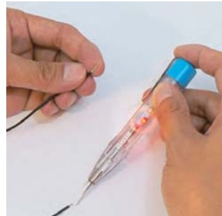
检查线路回路的导通情况。 ( 仅限于50MΩ以下的电路。 ) ※请务必首先确认没有通电，然后再进行检测。
