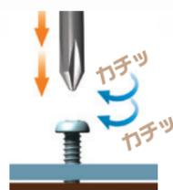
ネジ締め直後にトルクアップしてもカウントしないようにできます。
