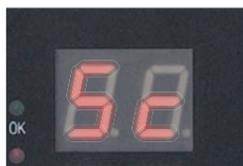
0~99までのネジ締め付け本数を液晶に表示します。
