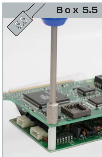
M3 ネジのナットに使える 対辺 5.5mm のソケット差替軸。
