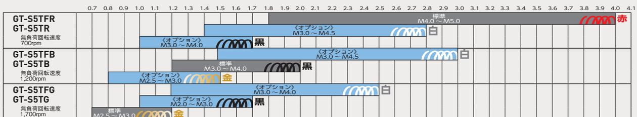
普通ネジ径 2.5~3mm 設定したトルクに達すると自動的にエアをシャットアウト。
