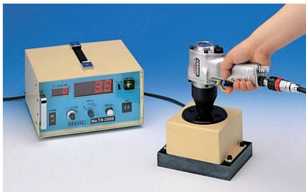
締め付けツールの出力管理、トルクレンチの精度確認に効果的です。インパクトツールの測定は、適正測定範囲の70%以内でご使用ください。
