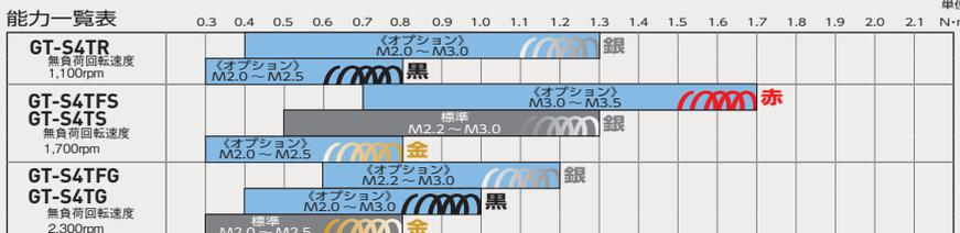
GT-S4T/S5T シリーズは、オプションのトルクスプリングを取り替えるだけで、簡単に締め付けトルク範囲が調整できます。調整の際は、ネジの締め付けトルク値がトルク範囲の中央にくるようなトルクスプリングを組み合わせるのが最良です。
