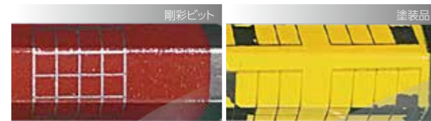
はがれテスト比較(テープカット試験による評価 JIS K-5600-5-6に基づく。)
